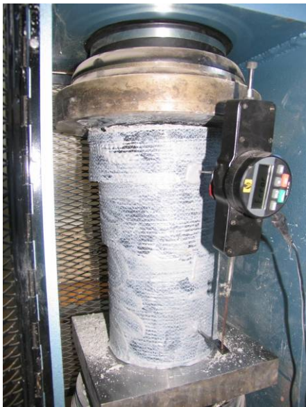
Πτυχιακή Εργασία: Περίσφιξη σκυροδέματος με εξωτερικά επικολημένο σπλισμό ινοπλισμένου πολυμερούς, υπο αξονική φόρτιση
